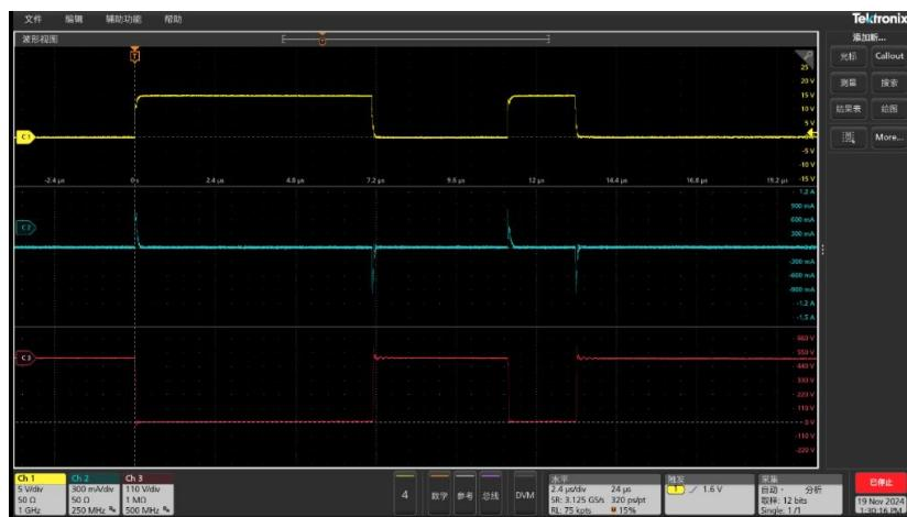
3、展示了在较快的上升/下降时间（500V/15ns）的共模干扰工况下，测试上管V<sub>GS</sub>电压的波形，知用的高压差分探头所测结果虽略逊于光隔离电压探头的波形（如红圈处），但已经远优于市售同类竞品探头。此结果印证知用差分探头的共模抑制比较优，是一种低成本浮地V<sub>GS</sub>测量方案。
