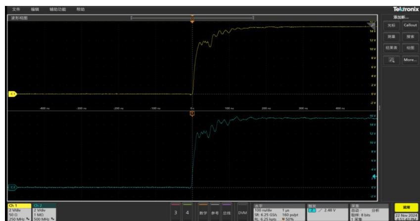
4、采用知用的光隔离电压探头和高压差分探头对上管进行测试，在较快的上升/下降时间（500V/15ns）的共模干扰工况下，2个探头波形完全一致。这一点再一次印证了知用的差分探头的共模抑制比较为优秀，亦是一种可采用低成本的浮地  $V_{DS}$  电压的测量方案。
